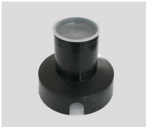
Installare la cassaforma posizionando la parte superiore a filo pavimento. Applicare il tappo in dotazione al fine di evitare l'entrata di corpi estranei nel pozzetto. Prevedere un adeguato drenaggio sotto la cassaforma.
