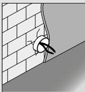
Effettuare il passaggio dei cavi attraverso il tubo elettrico. Eseguire il collegamento secondo lo schema e inserire il faretto applicando una leggera pressione.
