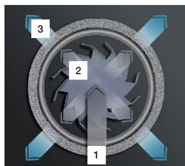
**Una soluzione pulita!** L'aria carica di grassi, odori e sostanze in sospensione viene aspirata dalla ruota del ventilatore (1). Questa fa passare l'aria carica attraverso la resistenza direttamente nel catalizzatore. (2). Tutti i residui vengono trasformati in acqua e anidride carbonica. L'aria pulita viene ricondotta nel forno. (3). In questo modo non vi sono depositi sulle pareti interne del forno e non necessita una pulizia impegnativa.
